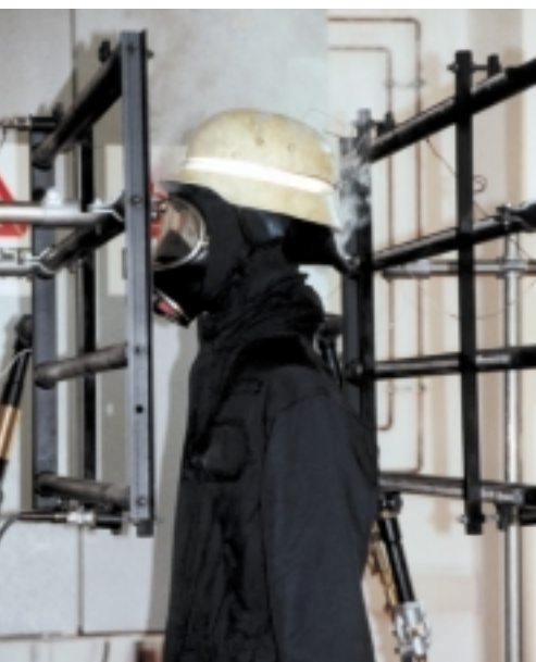
Bild 1 und 2: Prüfstand für Flame-Engulfment-Test
