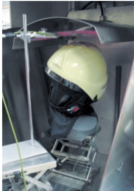
Bild 3: Prüfung der Beständigkeit gegenüber Strahlungswärme
