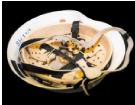
Bild 9: Helm nach Durchschlagsprüfung
