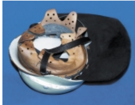
Bild 1: Beschädigter Helm mit herausgedrückter Innenausstattung
