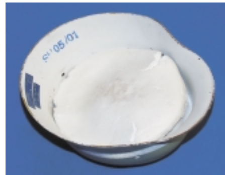
Bild 2: Aus der Helmschale hochgedrücktes Isoliermaterial
