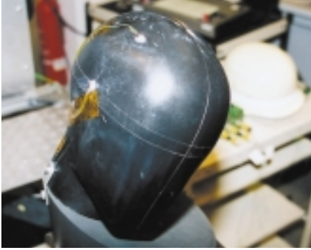
Bild 4: Prüfkopf mit Temperaturfühlem
