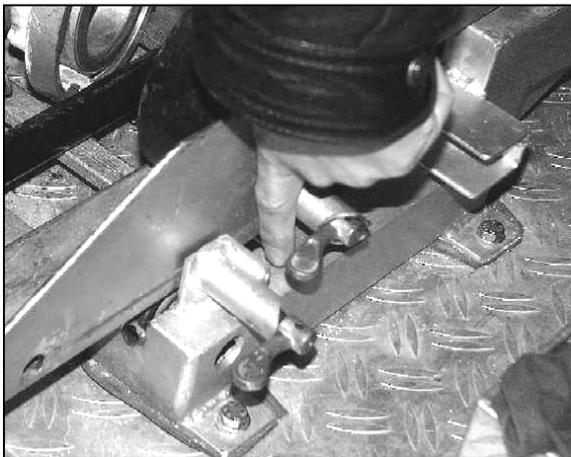
Bild 2: Montiertes Abweisblech
