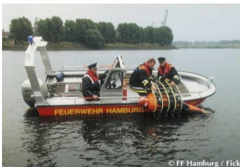
Abb. 10-12: Anwendung einer Einholhilfe zur Personenrettung
