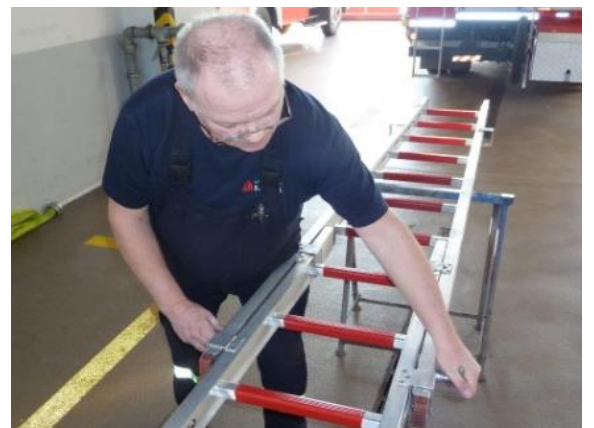
Sicht- und Funktionsprüfung an einer Steckleiter
