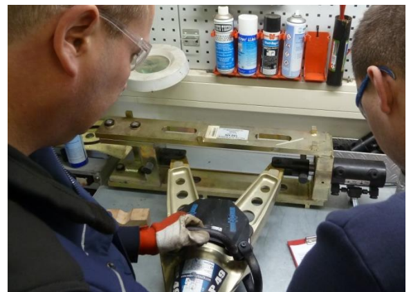
Regelmäßige Prüfung eines hydraulischen Rettungsgerätes, hier: Spreizer bei der Funktions- und Belastungsprüfung
