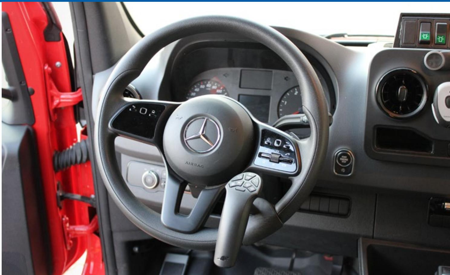
Das umgebaute Lenkrad mit dem Multifunktionsdrehknopf
