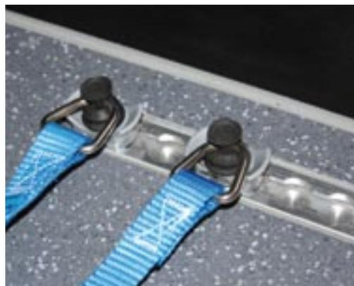
*Spezielle Verzurrschienen am Boden oder an den Seiten sind ideale Voraussetzungen für gute Ladungssicherung.*
