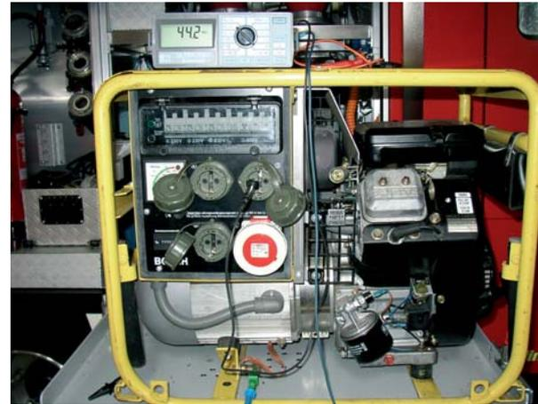
Stromerzeuger in Prüfung durch eine Elektrofachkraft
