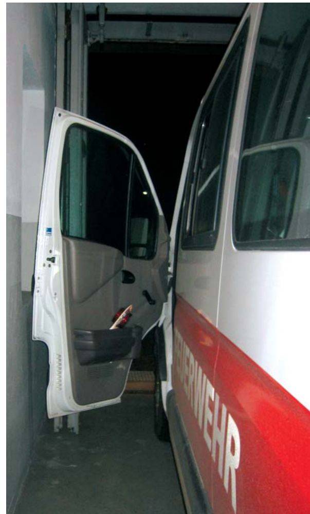
Fehlender Verkehrsweg bei geöffneter Fahrzeugtür
