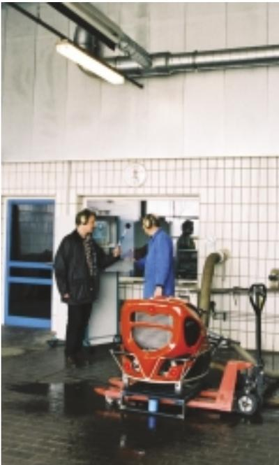
Pumpenprüfstand in der FTZ Wehrbleck einschließlich der Dämmung an Wand und Decke.
