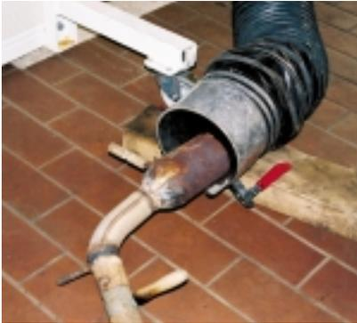
Das selbstgestellte Übergangsstück verbessert die Absaugleistung durch Minimierung der Querschnittsprünge.
