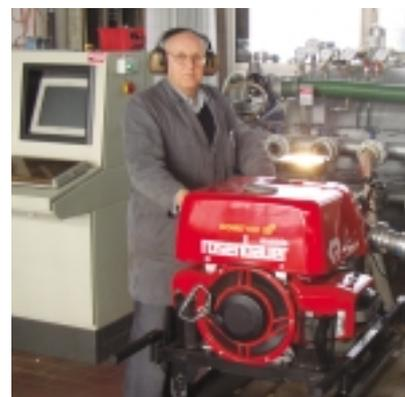
Der Pumpenprüfstand in der FTZ Syke-Barrien.
