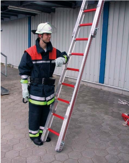
So kann der richtige Anstellwinkel überprüft werden.
