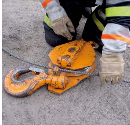
Einlegen des Drahtseiles in die Rolle
