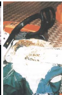
Kennzeichnung für: Schnittschutzhose Schutz gegen tragbare nach Unfall Kettensägen
