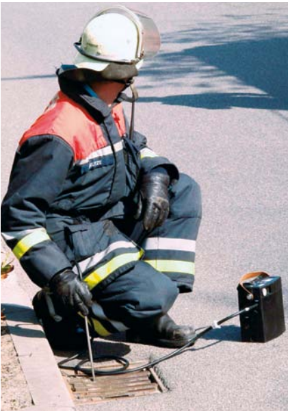
Messgeräte-Einsatz zur Feststellung von Explosionsgefahren
