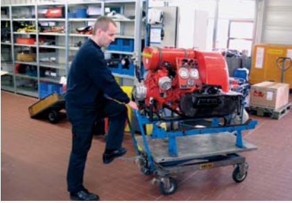
Transportwagen für Tragkraftspritzen mit mechanischer Höhenverstellung
