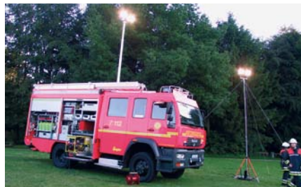
Lichtmast am Löschfahrzeug und abgespanntes Teleskop-Dreibeinstativ
