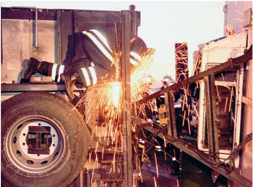
Brennschneiden unter erschwerten Bedingungen nach einem LKW-Unfall
