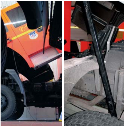
Gekipptes Führerhaus ... mit Sicherung gegen unbeabsichtigtes Absinken
