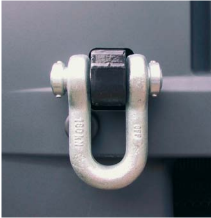
Festpunkt am Feuerwehrfahrzeug (160 kN)
