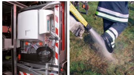
Reinigungsstation am Löschfahrzeug mit fließendem Wasser, Reinigungs- und Pflegemitteln aus Direktspendern und Einmalhandtüchern
