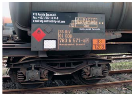
Eisenbahnwaggon – Warntafel mit Kennzeichnungsnummern und Gefahrzettel
