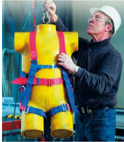
Persönliche Schutzausrüstungen gegen Absturz unterliegen einer EG-Baumusterprüfung durch eine Prüf- und Zertifizierungsstelle.
