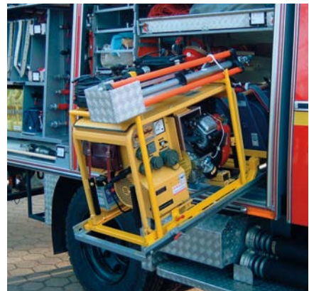
Schräglagerung des Geräteschlittens
