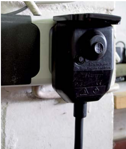
Verwendung eines Personenschutzschalters
