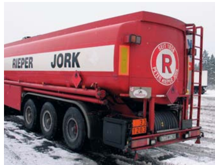
Tankfahrzeug – Warntafel mit Kennzeichnungsnummern und Gefahrzetteln
