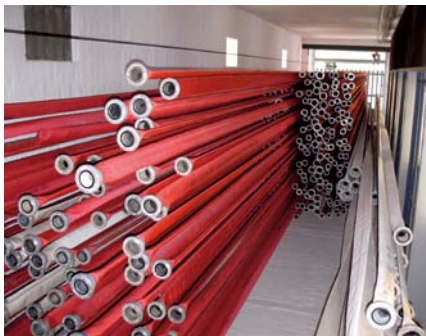
Schlauchtrocknung im Turm
