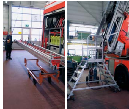
Hebezeugeinsatz und Transportwagen zum sicheren und körpergerechten Transport der Schiebleiter
