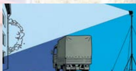
Hoch angeordnete Lichtquellen verringern die Schattenbildung.
