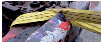
Vorsicht! Hebebänder nicht über scharfe Kanten spannen.
