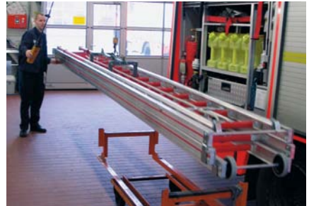
Hebezeugeinsatz und Transportwagen zum sicheren und körpergerechten Transport der Schiebleiter
