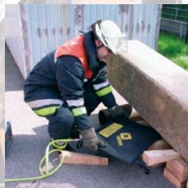
Hebekissen weit einschieben – mind. 75 % unter die Last
